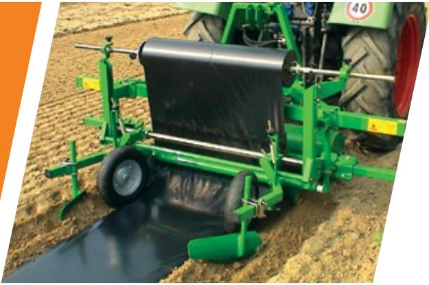
La **PACCIAMATRICE** è la macchina per stendere film di plastica o carta. È disponibile in tre modelli: V140 con larghezza di lavoro regolabile fino al massimo di 1,40 m, V190 con larghezza di lavoro regolabile fino al massimo di 1,90 m e V210 con larghezza di lavoro regolabile fino al massimo di 2,10 m.
